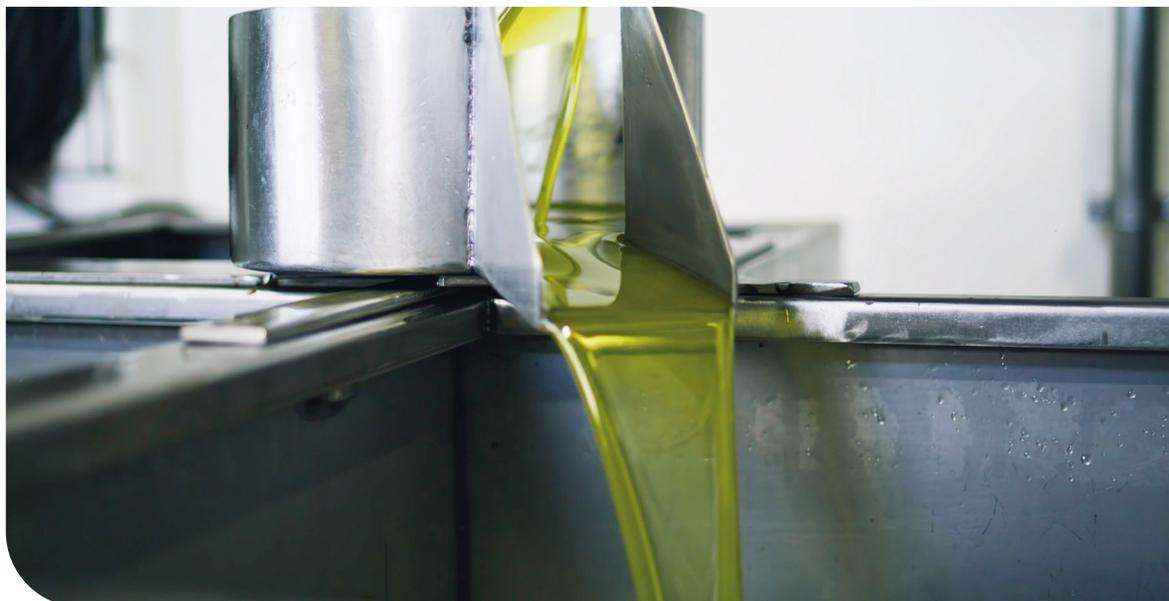
Composta da 2 vasche, una pompa di travaso e 4 celle di carico, la bilancia pesa olio è molto comoda per la lavorazione di grandi partite in continuo e non.
