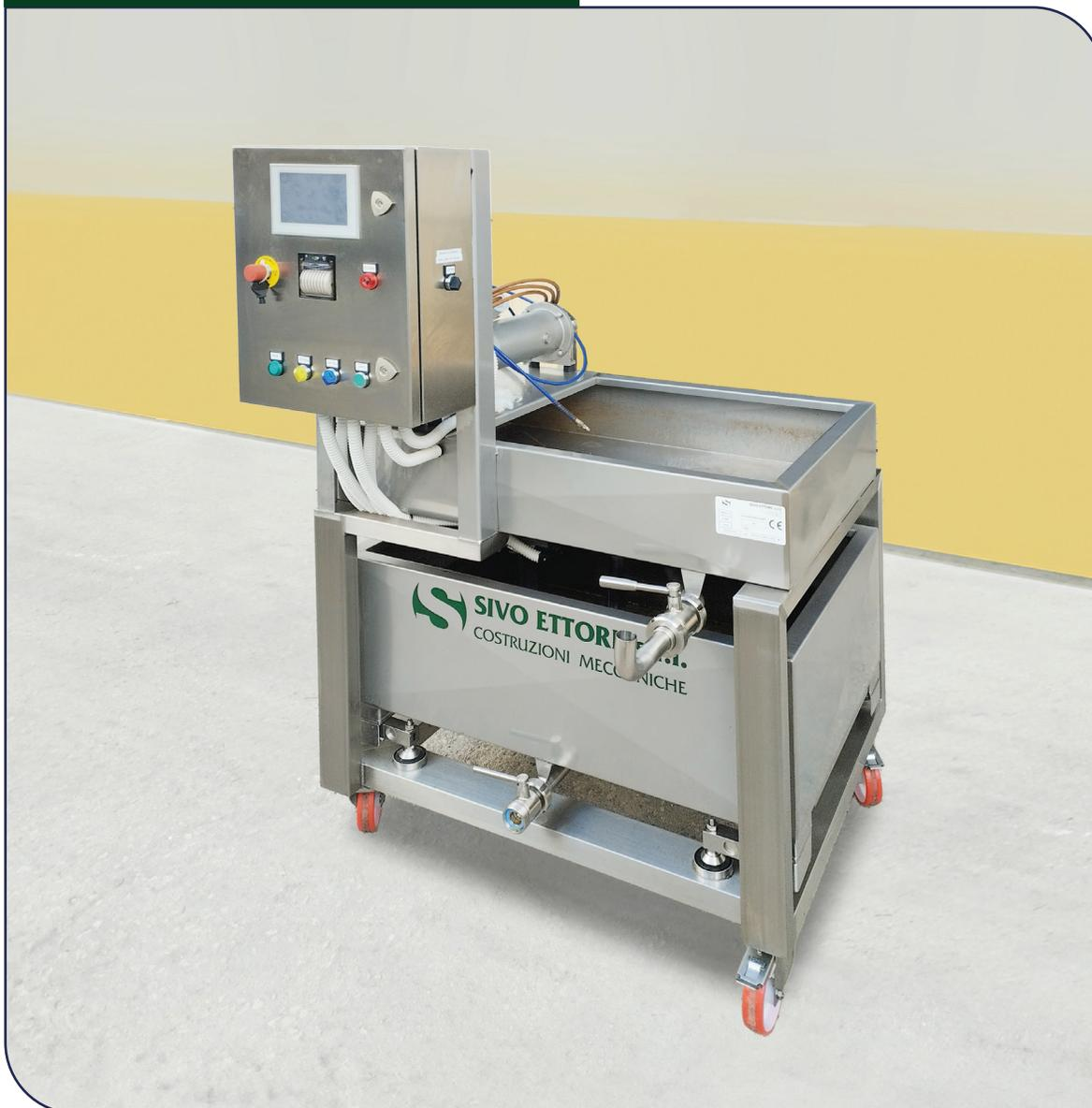
La **bilancia pesa olio** è una macchina totalmente costruita in acciaio inox aisi 304 e va installata direttamente in uscita dalla centrifuga ad asse verticale.
