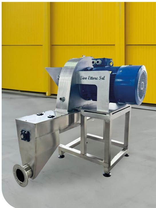
Il **Frangitore** è costruito in modo da poter alloggiare al suo interno il **rotore a coltelli**, che genera un minor attrito all'interno della camera di frantumazione, e di conseguenza si creano minori assorbimenti, minor usura meccanica, e miglior qualità di olio.
