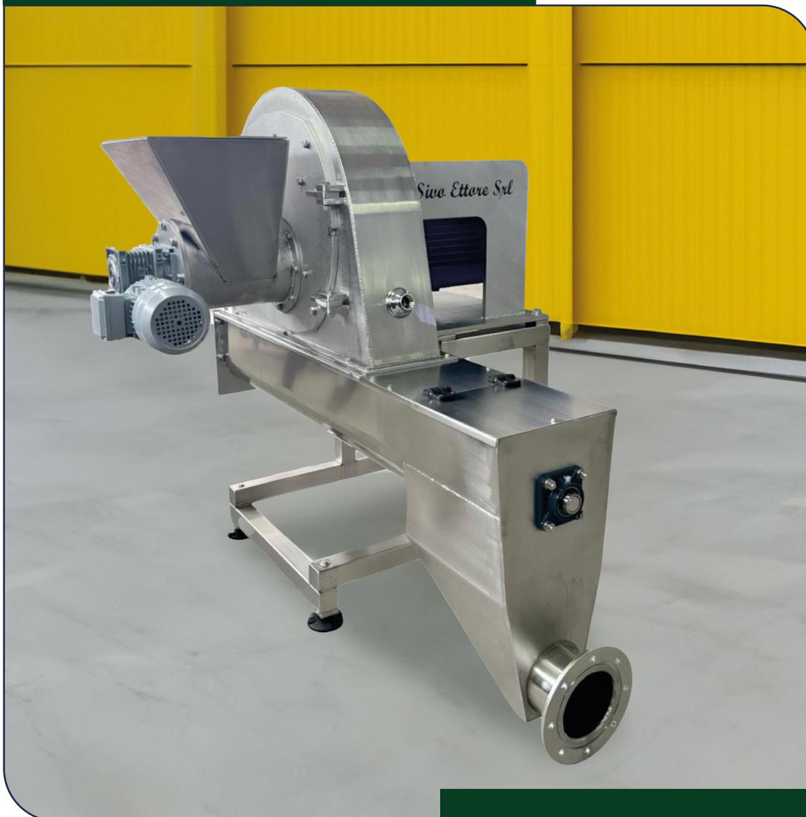
Il **frangitore** è costituito da una carcassa in acciaio inox aisi 304, un motore elettrico per la frangitura ed un motore elettrico per l'alimentazione della camera di frangitura.
